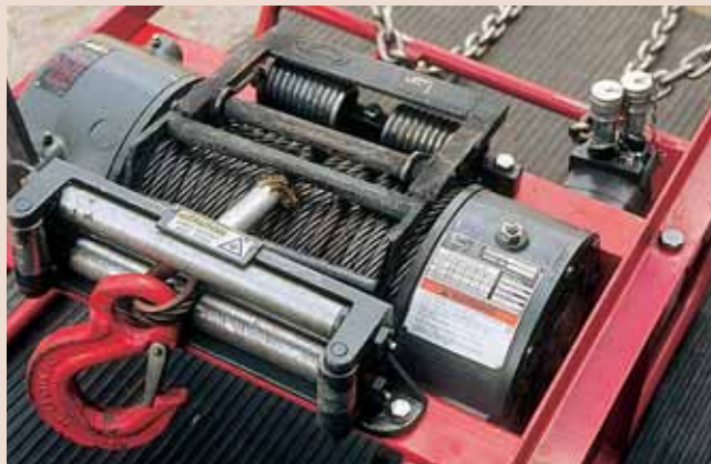
Роликовые губки и тросоукладчик ощутимо облегчают работу с лебедкой. Особенно заметно упрощается процесс перемотки троса.
