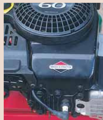
Гидростанция приводится шестисильным бензиновым двигателем американской фирмы Briggs&Stratton.
