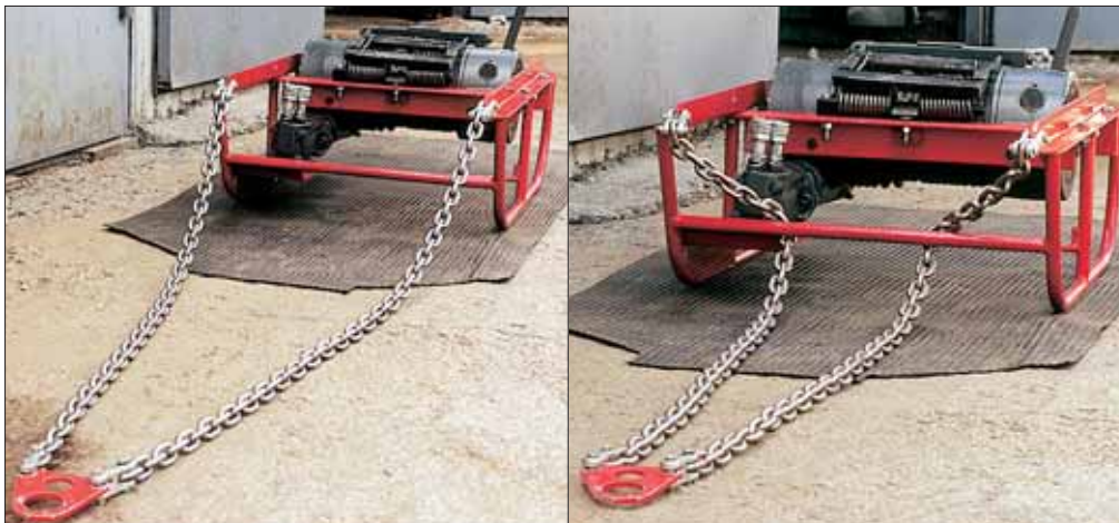
Два основных варианта зацепления лебедки. Слева – основное рабоче-тяговое, справа – дополнительное транспортно-санное. Разница в направлении и точке приложения усилий. Путь нежелательно...
