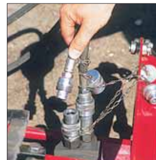
Гидростанция соединяется с лебедкой при помощи двухметровых шлангов. Последние оборудованы быстроразъемными штуцерами с запорными клапанами, препятствующими вытеканию масла при разъединении компонентов установки.
