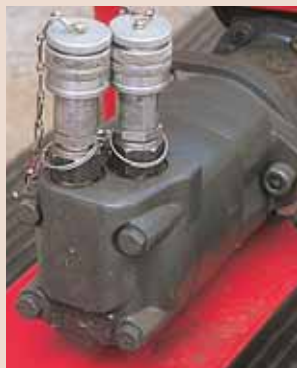
Аксиально-поршневой гидромотор – это самое настоящее «сердце» гидравлической лебедки.
