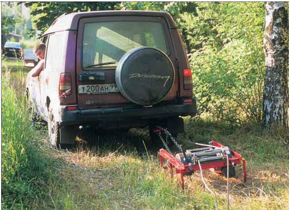
В конструкцию лебедки заложена возможность «буксировки», что нелишне при таком весе оборудования.
