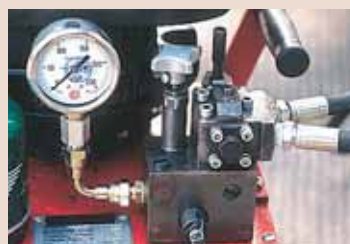
Меняя направление потока жидкости, гидрораспределитель дает возможность управлять лебедкой.
