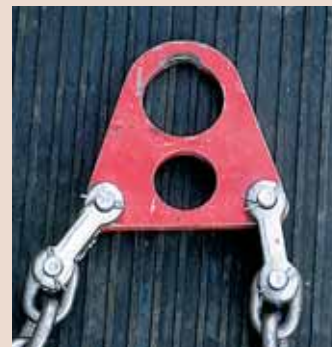
Размеры «серьги» позволяют использовать не только все размеры шаклов, но и цеплять лебедку за стандартный фаркоп.
