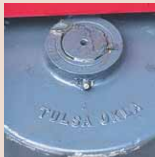
Грузовой вал лебедки опирается о надежные шприцуемые бронзовые втулки. Причем их солидный размер позволяет не бояться динамических нагрузок.
